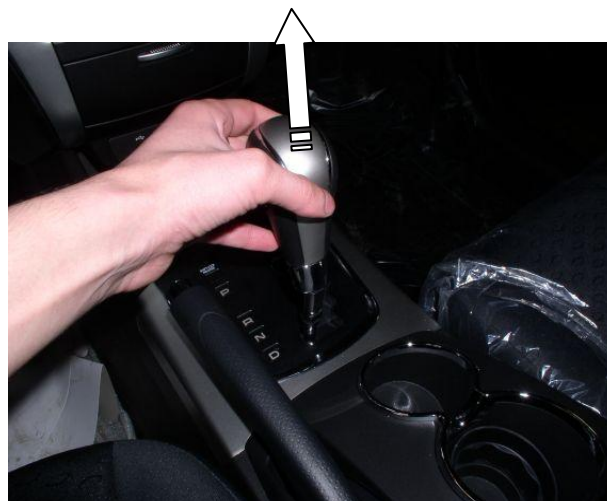
Снять рукоятку рычага переключения передач
