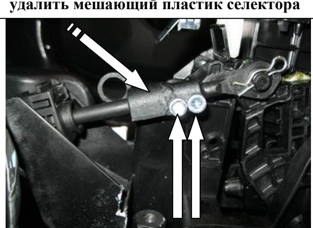
Установить хомут на тягу, зафиксировать 2 винтами
