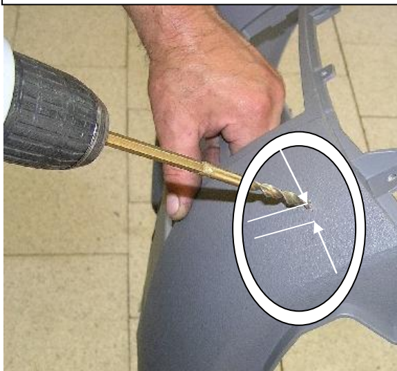
Просверлить отверстие с отступом 5 мм. от точки разметки шаблона
