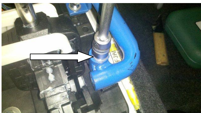
Установить замок на пластину-переходник, закрутить болт
