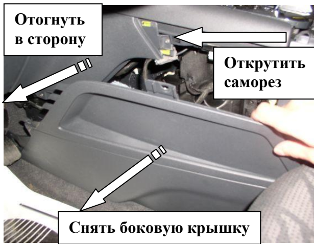
Снять боковую крышку
