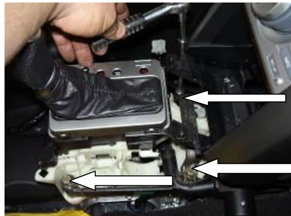
Установить замок, закрутить 3 срывных болта
