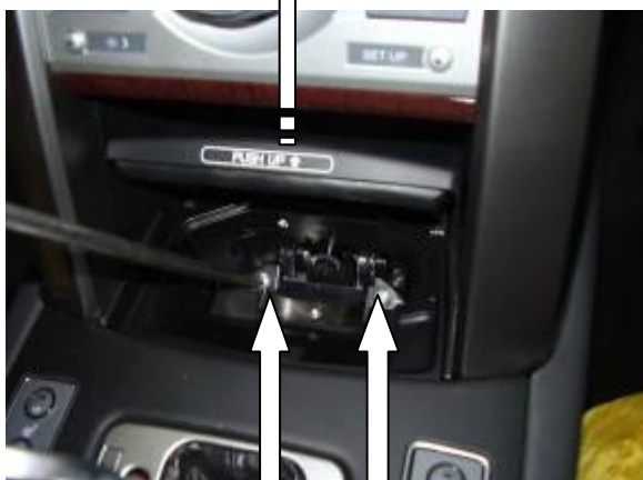
Поднять крышку, открутить 2 самореза
