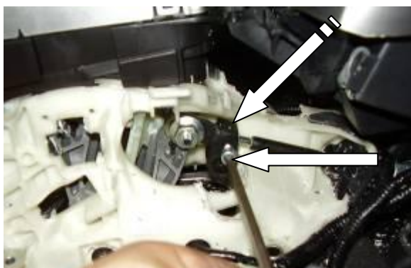
Установить хомут на тягу, зафиксировать винтом, перевести рычаг переключения передач в положение «Р», произвести блокировку, отрегулировать положение хомута на тяге, сорвать винт
