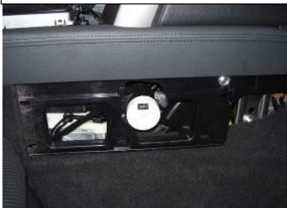
Разметить, используя разметочный шаблон, отверстие в ковровине под корпус замка
