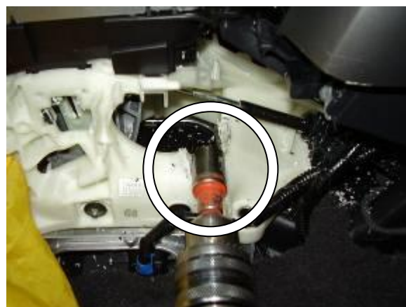
Удалить пластик селектора, мешающий установке замка
