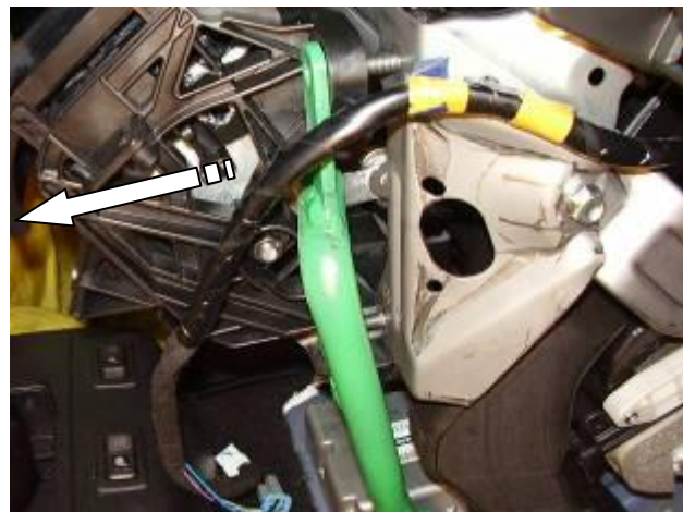
7 Снять селектор, установить замок на селектор, 8 установить селектор с замком на место
