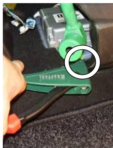
12 Зафиксировать лапку замка на днище с помощью заклёпки и клепальника
