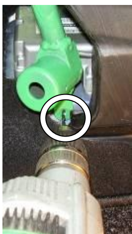
11 Просверлить крепёжное отверстие 4 мм. в днище сквозь отверстие в лапке замка
