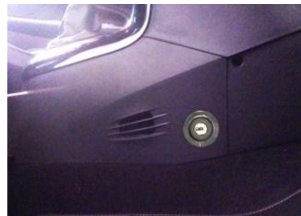
Разметить, используя разметочный шаблон, просверлить и расширить до 32 мм. отверстие в консоли под корпус замка, собрать консоль
