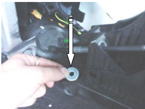
Установить шайбу на шпильку
