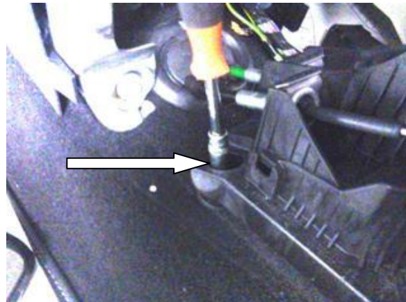
Открутить штатную гайку селектора
