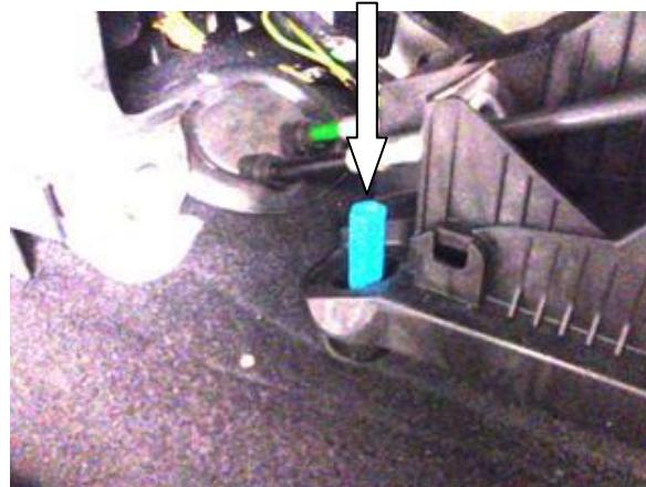
Установить шестигранный столбик на шпильку
