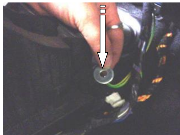
Установить шайбу на шпильку
