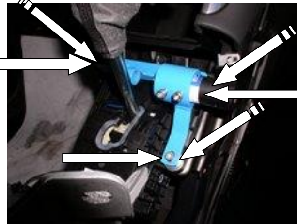
Установить на столбики кронштейн замка, закрутить 3 срывных болта
