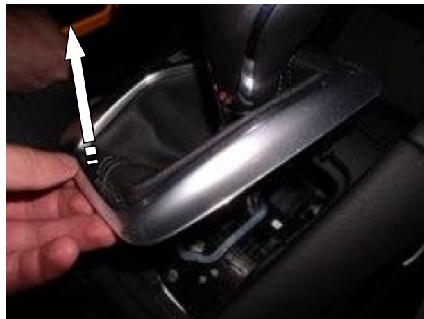
Снять декоративную панель и чехол рукоятки рычага переключения передач
