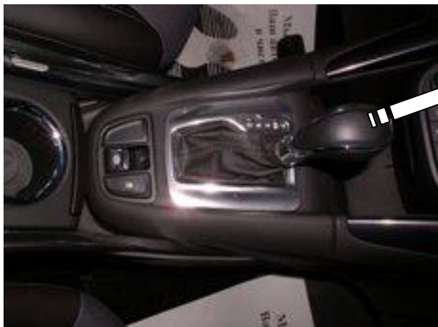
Снять рукоятку рычага переключения передач
