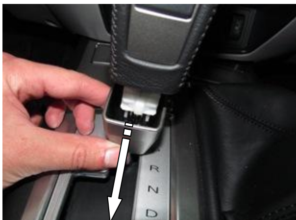
Снять декоративный колпак рукоятки рычага переключения передач
