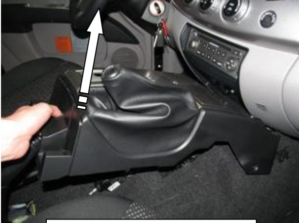
Снять переднюю консоль
