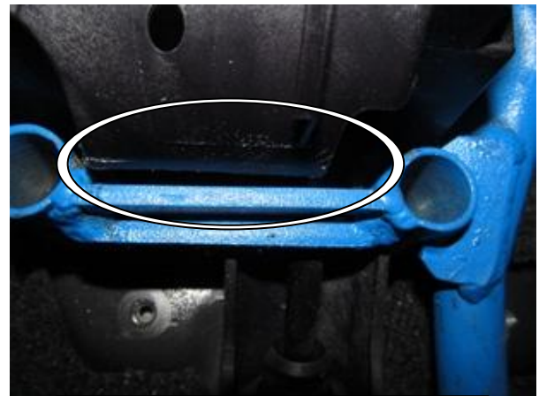
Открутить 2 штатные гайки селектора
