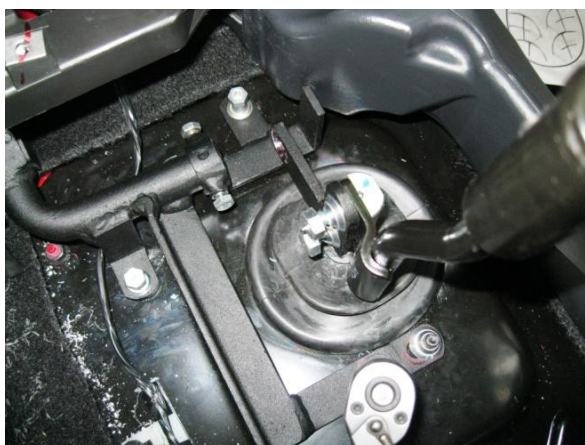
Перевести рычаг переключения передач в положение «R», произвести блокировку, при необходимости отрегулировать положение замка, сорвать болт и гайки
