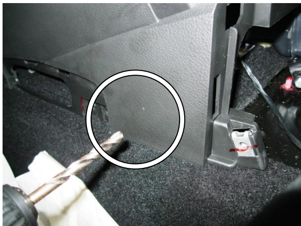
Просверлить отверстие по разметке
