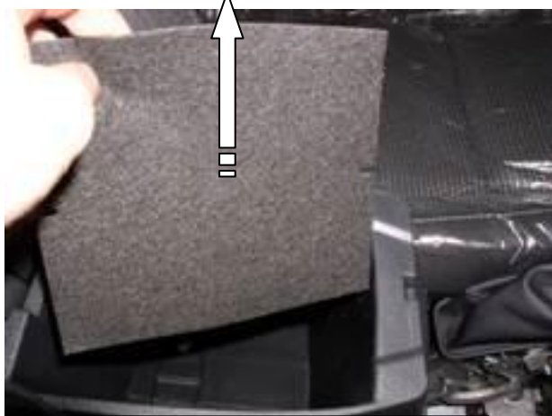
Поднять подлокотник, снять декоративную прокладку
