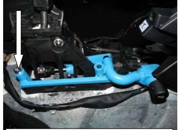
Снять воздуховод, установить замок, зафиксировать срывным болтом
