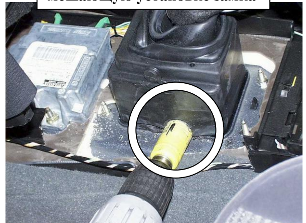
Просверлить отверстие в селекторе под трубу замка
