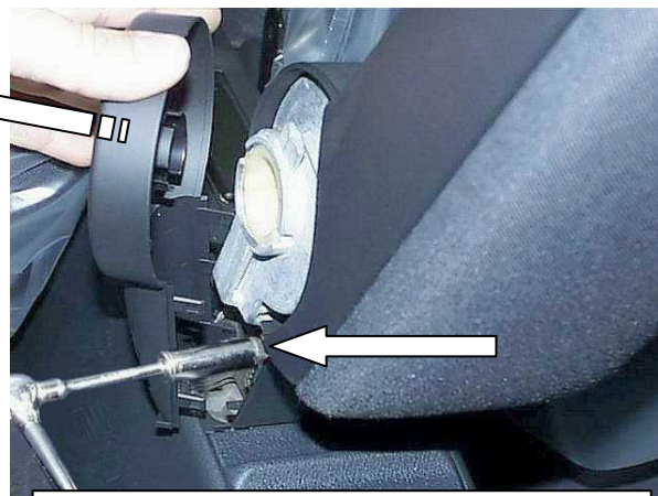
Снять крышку, открутить саморез
