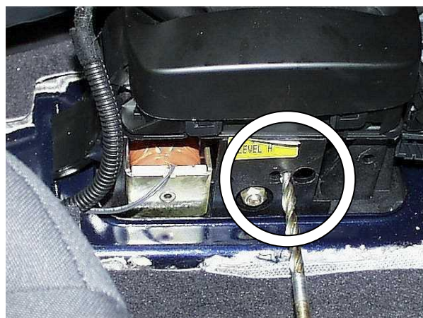
Просверлить отверстие в селекторе под трубу замка
