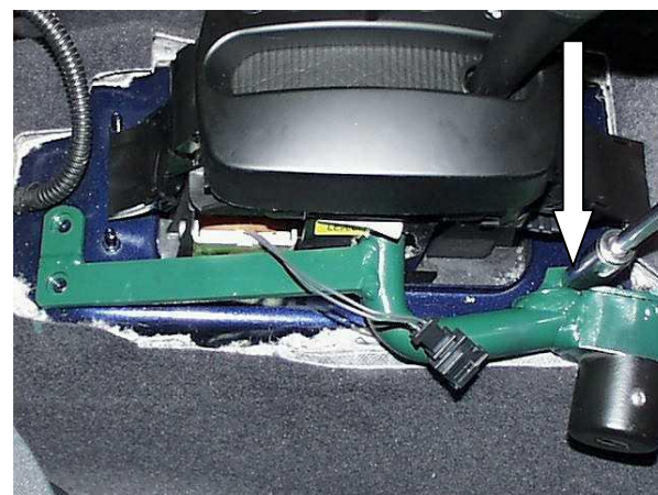
Установить замок лапкой на шпильку трубой в отверстие
