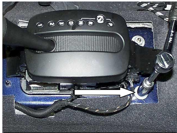
Открутить штатную гайку селектора
