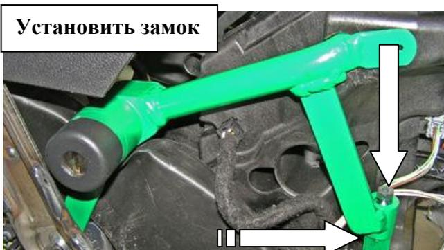
При необходимости, отрегулировать зазор между ригелем замка и рычагом переключения передач, подложив под лапку шайбу 6 мм.
