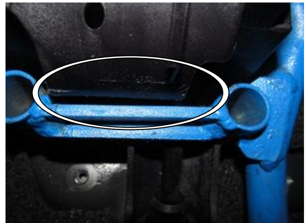
Открутить 2 штатные гайки селектора
