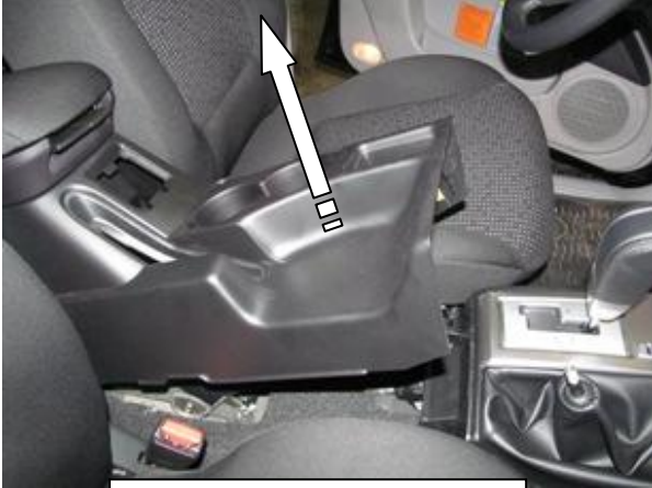
Снять заднюю консоль
