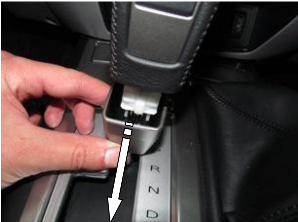
Снять декоративный колпак рукоятки рычага переключения передач
