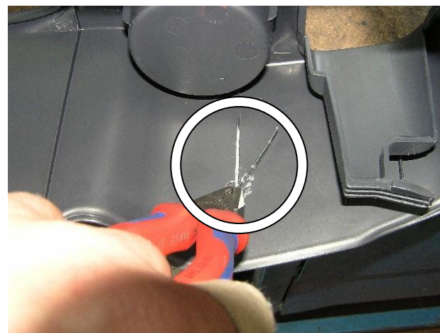
Удалить мешающие установке замка рёбра жёсткости
