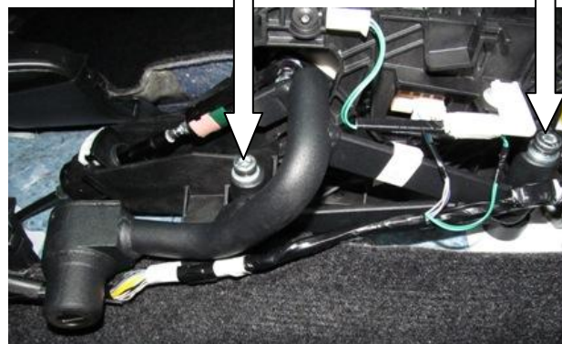
Установить замок на регулировочные шайбы, закрутить 2 срывных болта (не срывать!!!), перевести рычаг переключения передач в положение «Р», произвести и проверить блокировку, сорвать болты
