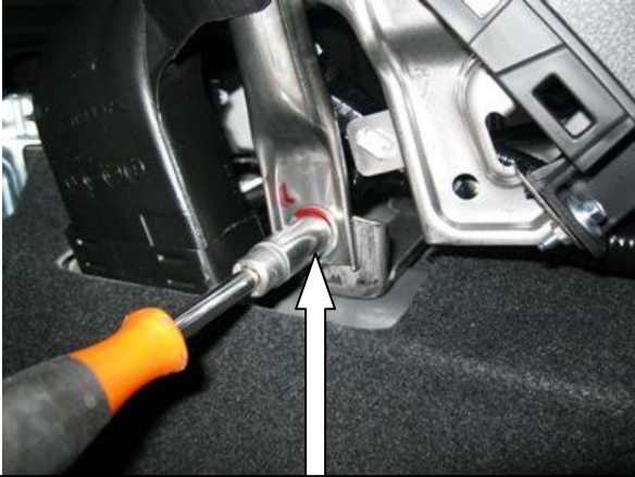
Открутить штатный болт селектора
