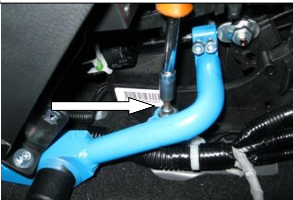
Закрутить срывной болт. Перевести рычаг переключения передач в положение «Р», произвести блокировку, отрегулировать положение хомута на тяге, сорвать винты.
