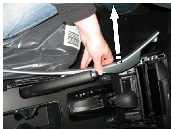
Снять декоративную планку
