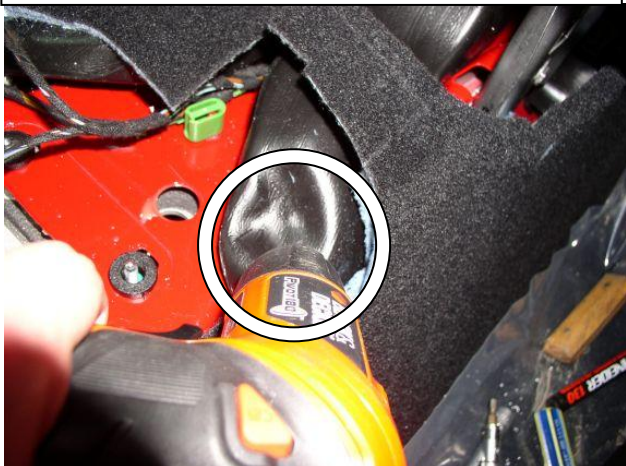
Нагреть воздуховод феном, сформировать выемку под корпус замка
