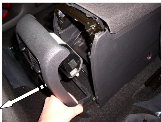
Снять заднюю панель
