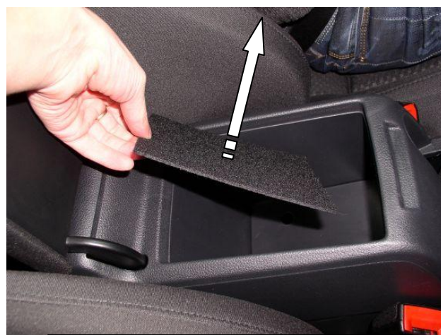
Снять декоративную прокладку
