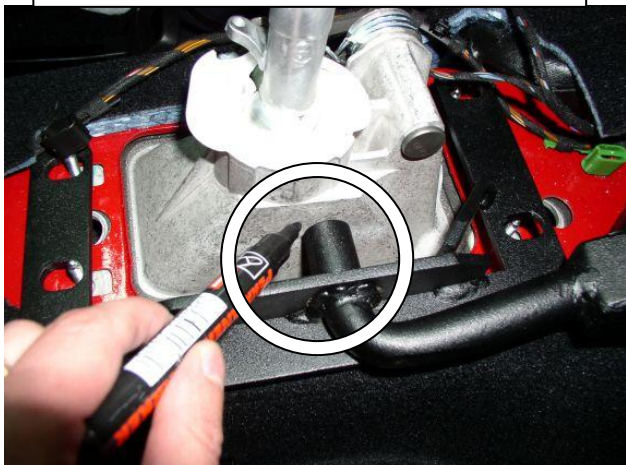
Установить замок на точки крепления, разметить место сверления селектора
