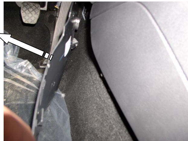
Снять боковую крышку
