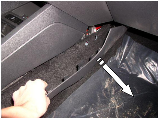
Снять боковую крышку
