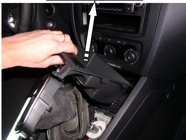
Снять верхнюю крышку
