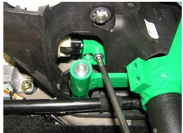
Перевести рычаг переключения передач в положение «R», произвести блокировку, отрегулировать положение хомута на тяге, сорвать винты
