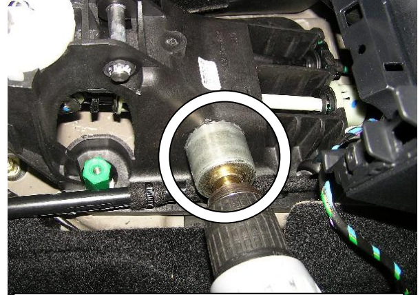
Просверлить отверстие в селекторе под прямоходный цилиндр
