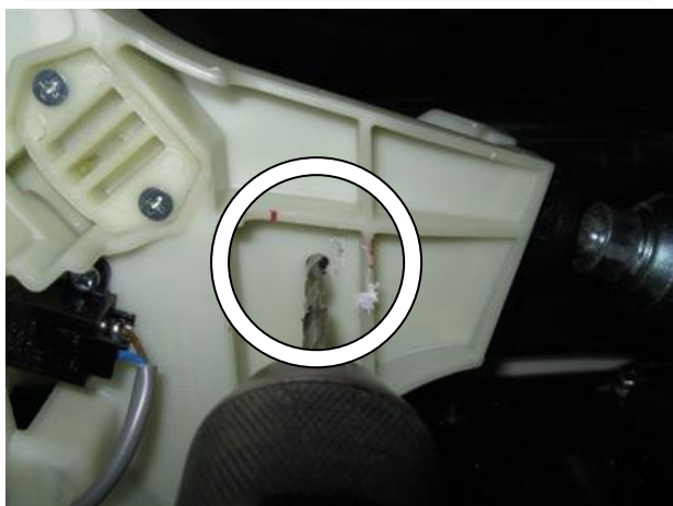
Просверлить отверстие в селекторе под трубу замка
