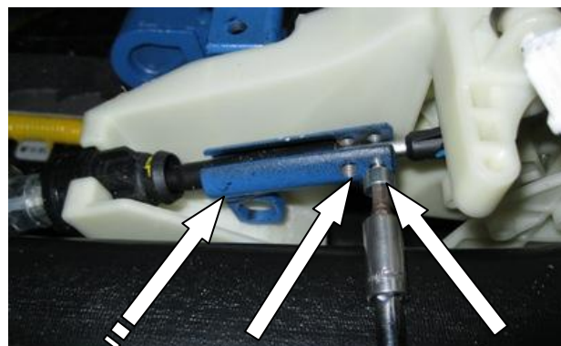
Установить хомут на тягу, перевести рычаг переключения передач в положение «R», произвести блокировку, отрегулировать положение хомута на тяге, зафиксировать хомут 2 винтами
