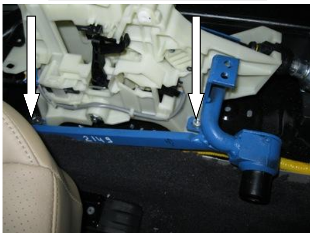
Установить замок трубой в отверстие, закрутить 2 срывных болта
