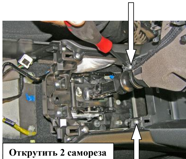
Снять декоративный кожух и верхнюю панель
