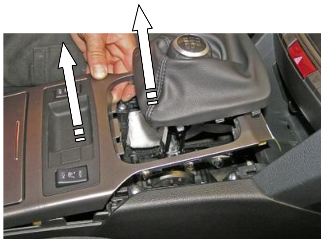
Снять декоративный кожух и верхнюю панель
