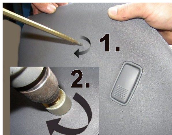
Просверлить и расширить отверстие, установить консоль на место
