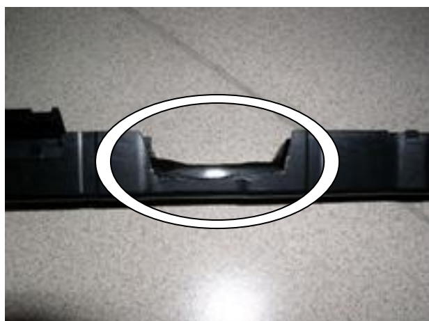
Снять воздуховод, удалить мешающий установке замка пластик воздуховода
