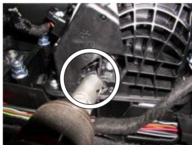
Просверлить отверстие в селекторе под трубу замка
