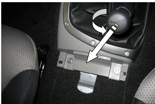
Открутить и снять рукоятку рычага раздатки
