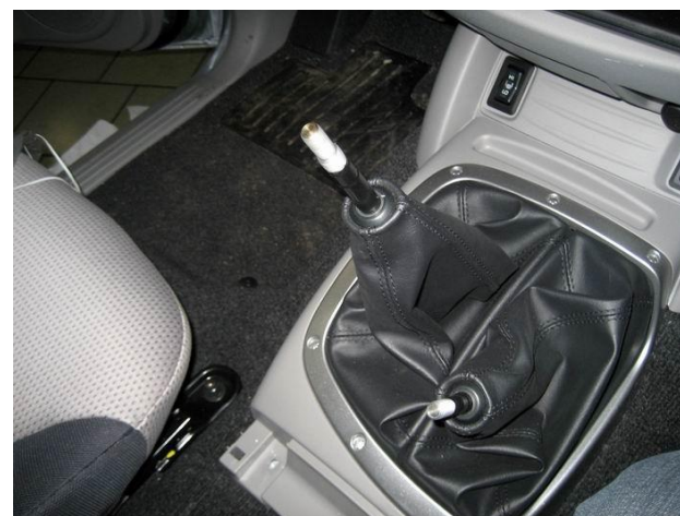
Открутить и снять рукоятку рычага раздатки
