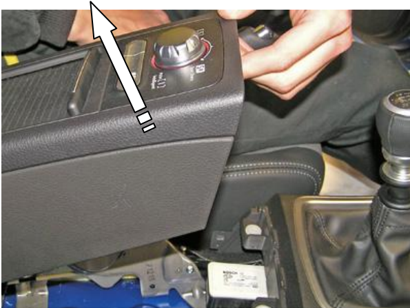
Снять верхнюю заднюю крышку
