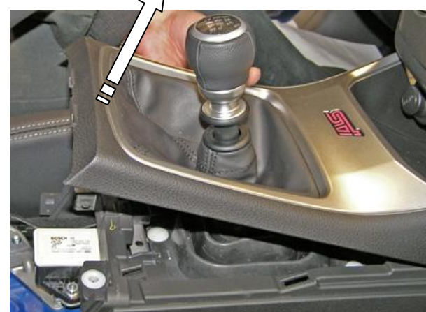
Снять верхнюю переднюю крышку
