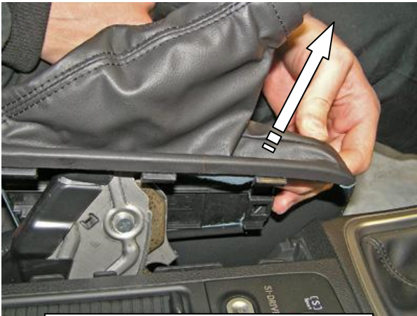
Снять декоративный чехол рычага стояночного тормоза
