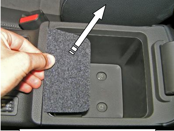
Поднять подлокотник, снять декоративную прокладку
