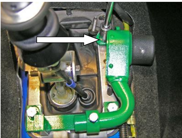
Установить замок трубой в кольцо кронштейна замка, зафиксировать лапку срывным болтом
