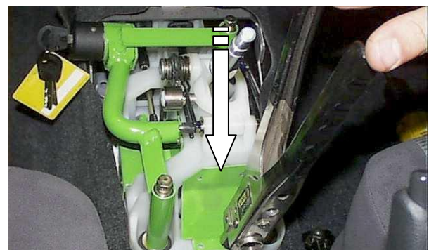
Установить защиту, просверлить отверстия в селекторе, зафиксировать защиту на селекторе заклёпками
