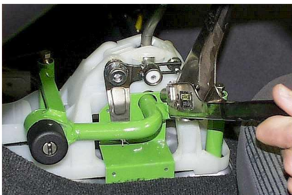
Зафиксировать защиту на селекторе заклёпками
