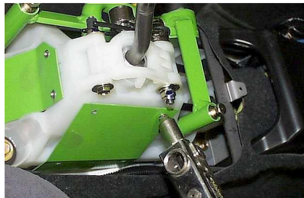
Зафиксировать защиту на селекторе заклёпками
