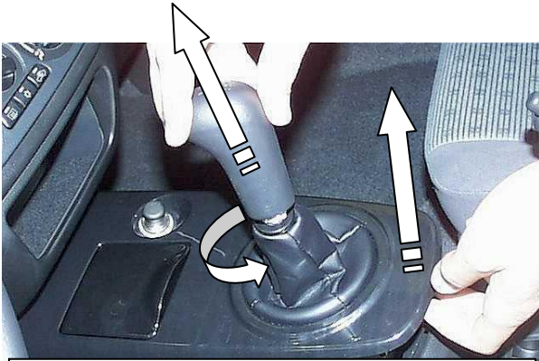
Открутить и снять рукоятку рычага переключения передач. Снять верхнюю крышку
