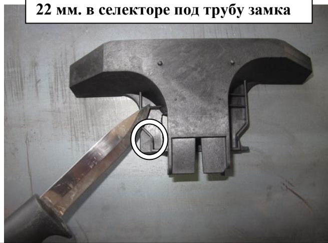
Удалить мешающее ребро жёсткости снятого заднего узла крепления консоли
