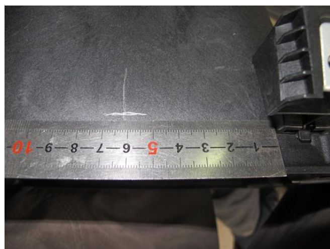
Разметить точку сверления селектора
