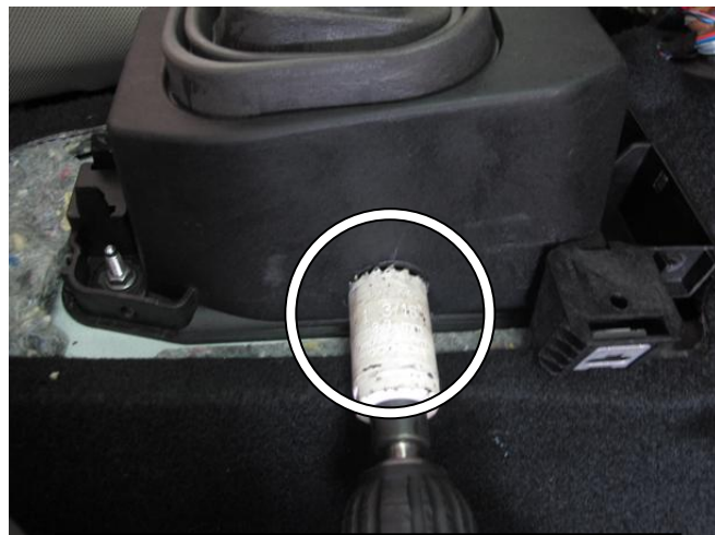
Просверлить по разметке отверстие 22 мм. в селекторе под трубу замка
