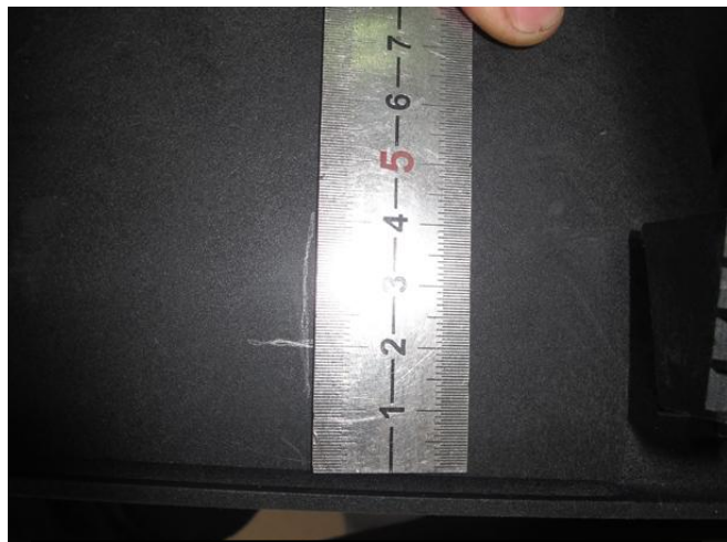
Разметить точку сверления селектора
