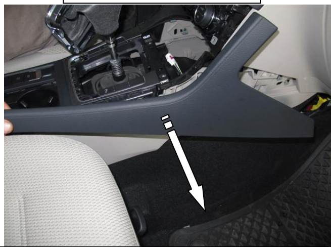
Снять декоративные накладки с обеих сторон
