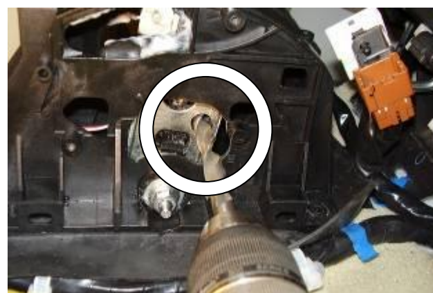
Расширить отверстие в детали рычага
