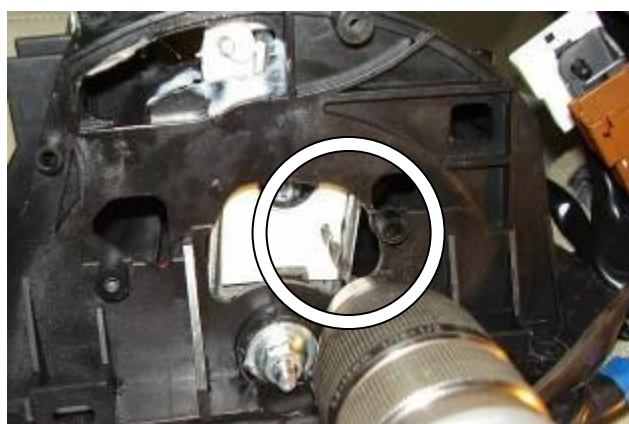
Просверлить отверстие в детали рычага
