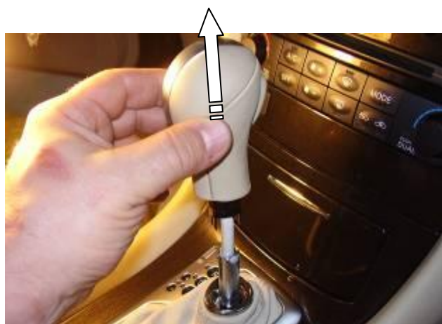
Снять рукоятку рычага переключения передач
