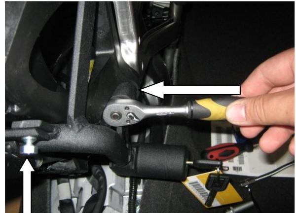
Открутить 3 штатных гайки селектора, установить на шпильки замок и кронштейн, предварительно соединив его с замком срывным болтом, закрутить срывную гайку
