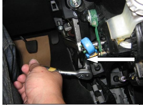
Открутить саморез, снять консоль
