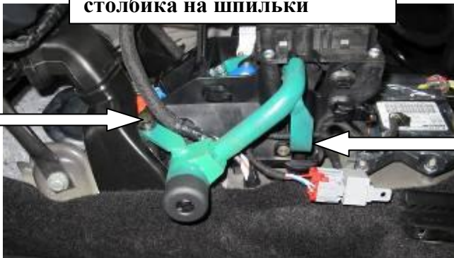
Установить замок на столбики, зафиксировать 2 срывными ботами Перевести рычаг переключения передач в положение «Р», произвести и проверить блокировку
