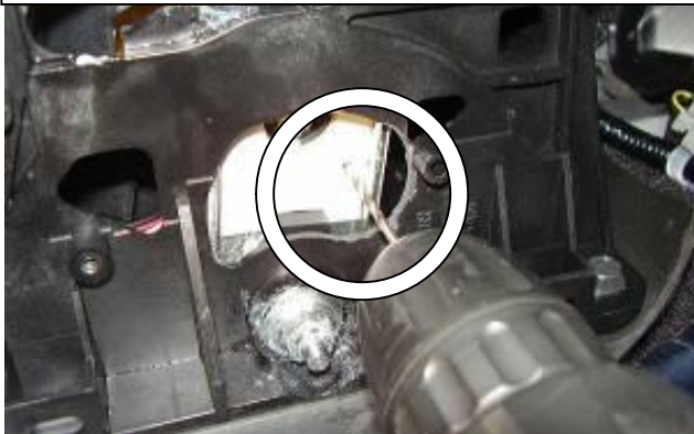
Просверлить отверстие под ригель замка в детали рычага переключения передач
