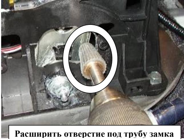
Просверлить отверстие под ригель замка в детали рычага переключения передач
