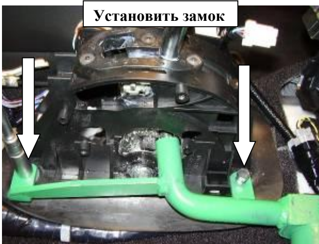
Разметить, используя разметочный шаблон, и просверлить отверстие в консоли под корпус замка
