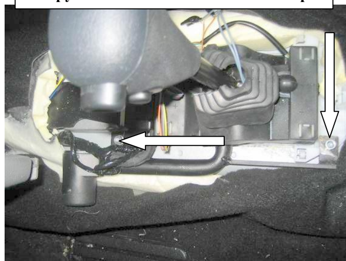
Установить замок на шпильки трубой в отверстие, перевести рычаг переключения передач в положение «Р», произвести и проверить блокировку рычага, зафиксировать замок 2 срывными гайками
