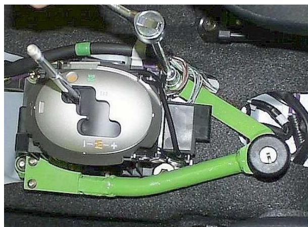
Перевести рычаг переключения передач в положение «Р», произвести и проверить блокировку рычага
