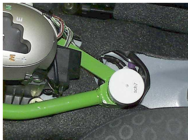
Разметить, используя разметочный шаблон, просверлить и расширить отверстие в верхней крышке под корпус замка
