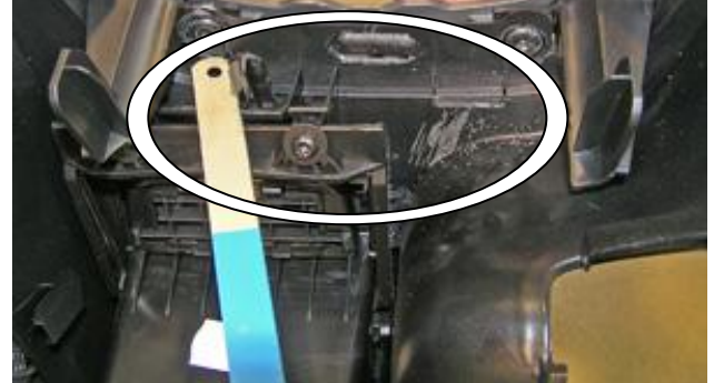
Удалить мешающий пластик консоли
