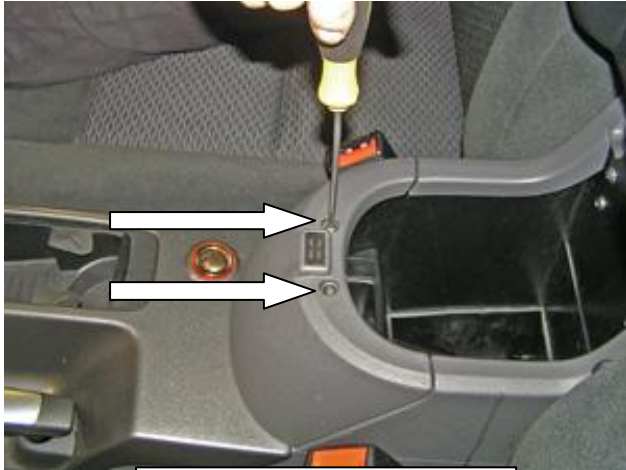
Поднять подлокотник, открутить 2 самореза
