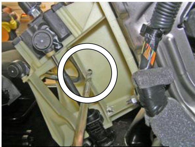
Просверлить отверстие в селекторе под трубу замка
