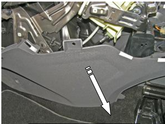
Снять переднюю консоль
