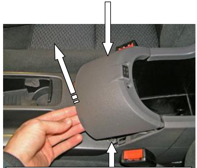
Снять крышку, открутить 2 самореза
