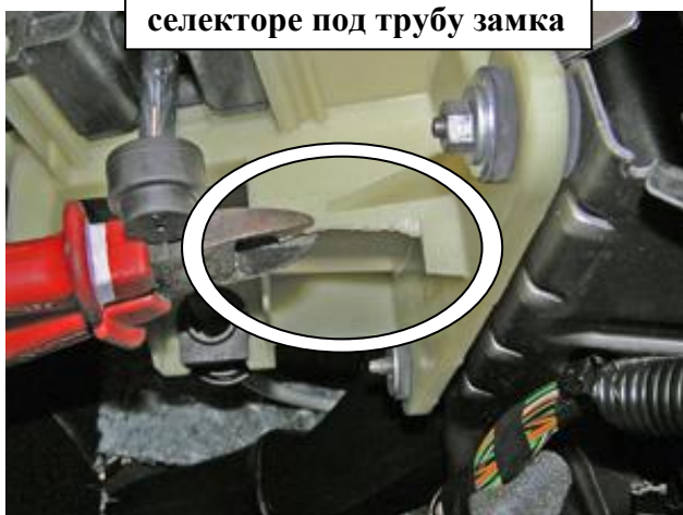
Удалить мешающий установке замка пластик селектора
