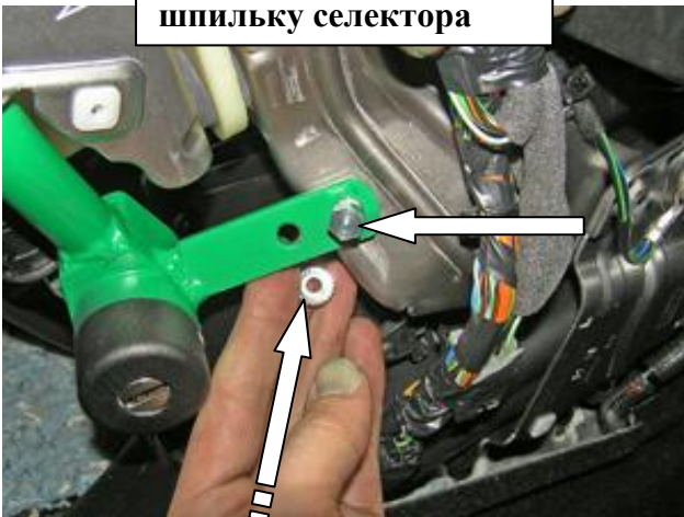
Зафиксировать лапку замка на стойке селектора срывным болтом и несрывной гайкой с обратной стороны стойки
