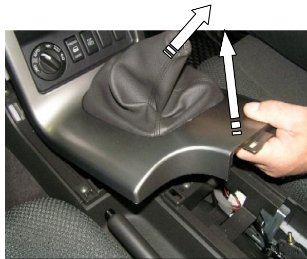
Снять верхнюю переднюю крышку, открутить и снять рукоятку рычага переключения передач
