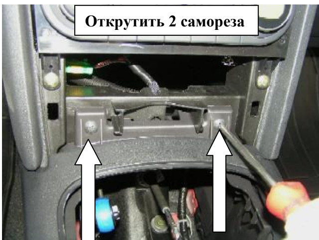
Открутить 2 самореза с обеих сторон
