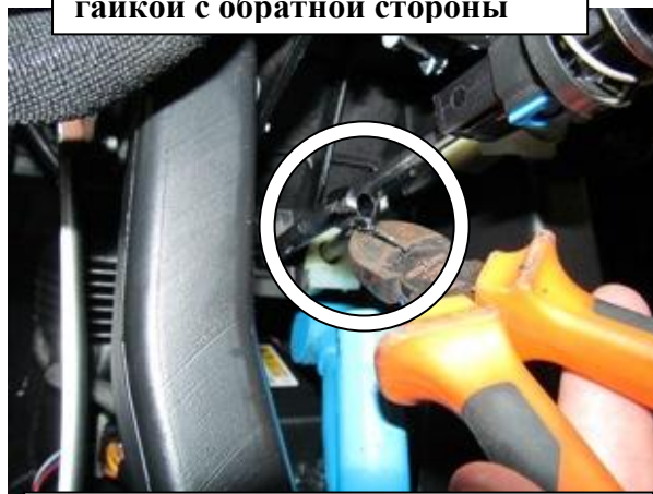
Удалить пластиковую оплётку тяги
