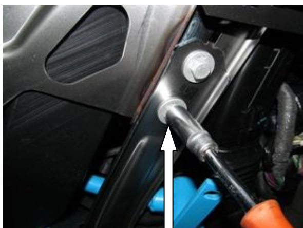
Открутить штатный болт селектора
