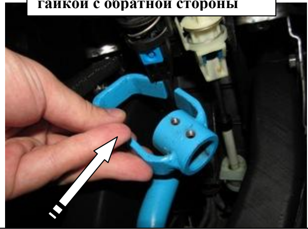
Установить защиту ригеля на трубу замка
