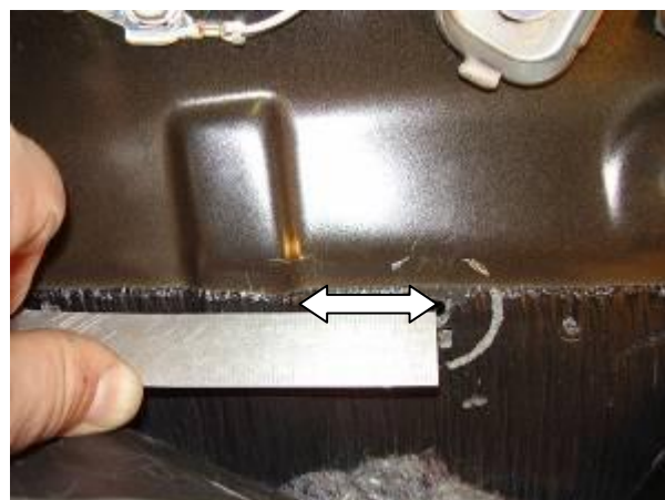
Разметить и просверлить отверстие 32 мм. в днище под прямоходный цилиндр
