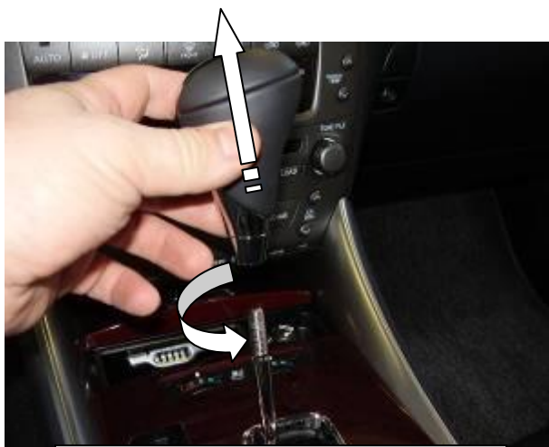
Открутить и снять рукоятку рычага переключения передач
