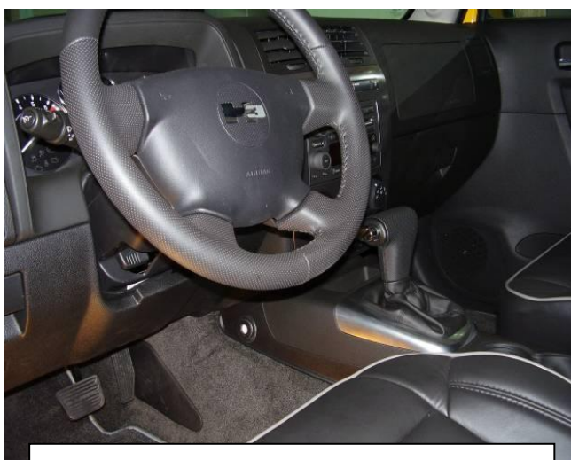
Просверлить и расширить отверстие в консоли под корпус замка, установить консоль на место
