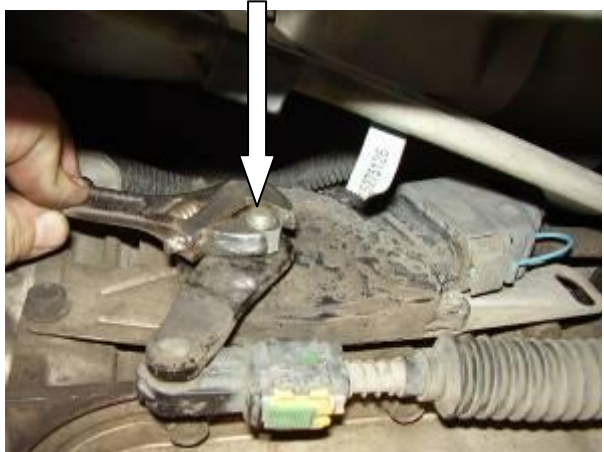
Под днищем открутить штатную гайку тяги
