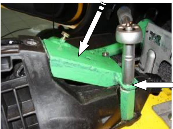
Установить защиту тяги на столбик, закрутить срывной болт
