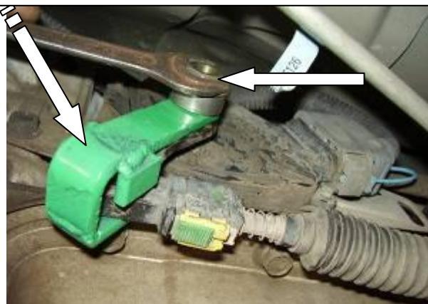
Установить защиту тяги, зафиксировать срывной гайкой
