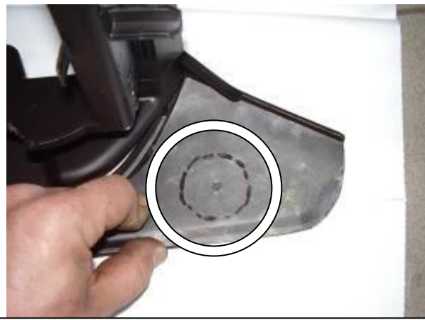
13 Разметить, используя разметочный шаблон, отверстие в консоли под корпус замка 14
