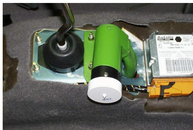
22 Разметить, используя разметочный шаблон, отверстие в консоли под корпус замка
