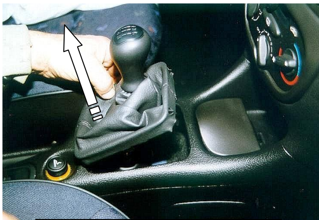
Снять декоративный кожух рычага переключения передач
