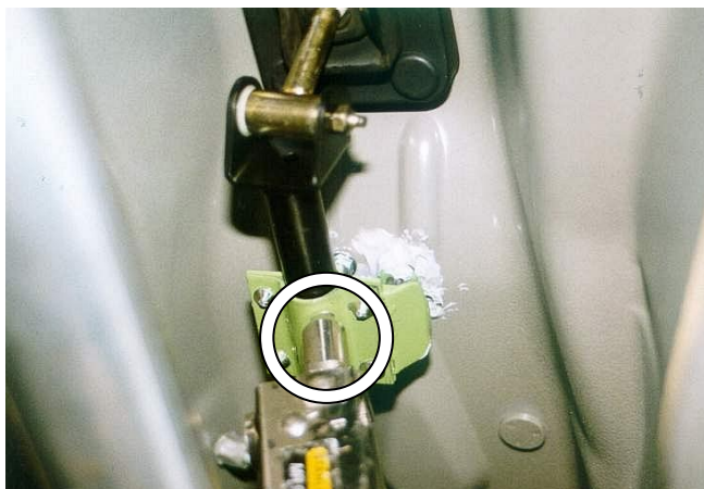
19 Дополнительно зафиксировать хомут на тяге с помощью заклёпки и клёпальника
