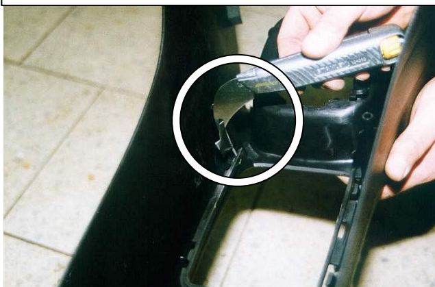
21 Удалить мешающий пластик консоли
