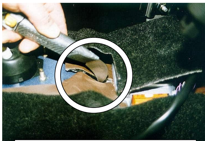
Удалить мешающую звукоизоляцию
