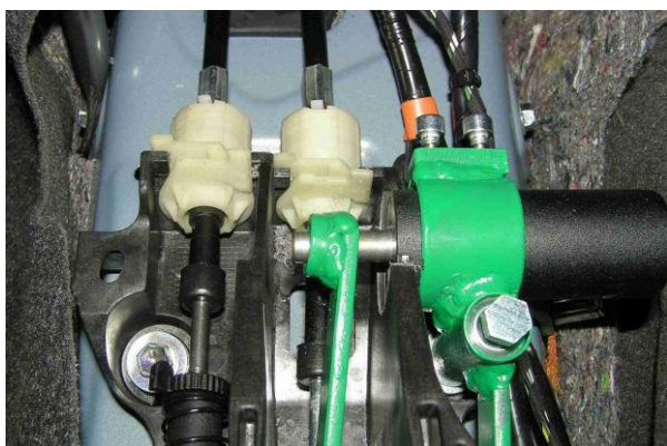
Перевести рычаг переключения передач в положение «R», произвести блокировку, отрегулировать положение хомута на тяге и цилиндра в кронштейне, сорвать винты
