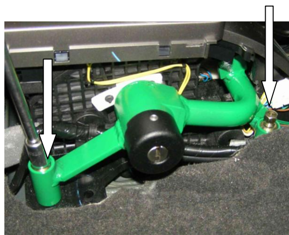
Повторно установить замок, проверить попадание ригеля в блокировочное отверстие, сорвать болты
