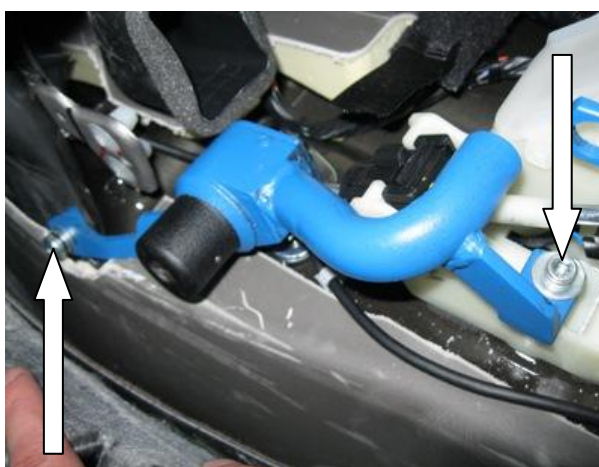
Установить замок, закрутить 2 срывных болта
