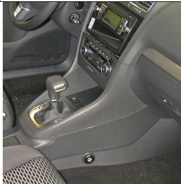
Разметить в консоли отверстие под корпус замка с помощью разметочного шаблона, просверлить отверстие, установить консоль на место
