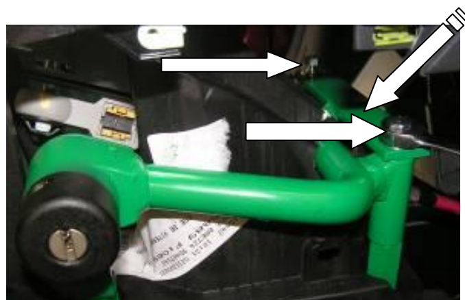
Установить деталь-защиту тяг на столбик и замок, закрутить 2 болта
