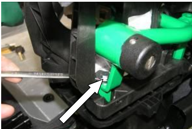
Установить замок на столбики, закрутить болт
