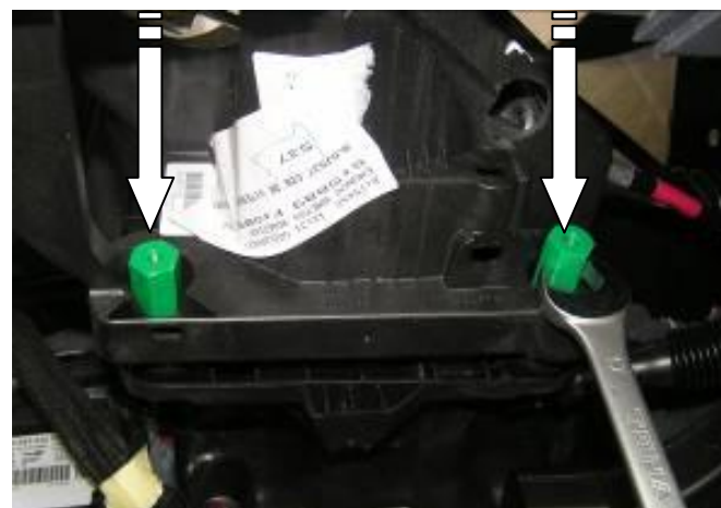
Установить на шпильки столбики 50 и 40 мм.
