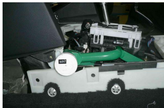
Разметить, используя разметочный шаблон, отверстие в консоли под корпус замка
