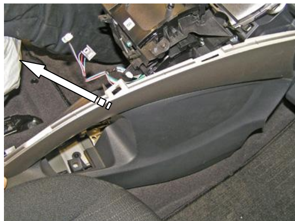
Снять переднюю консоль
