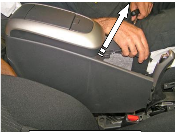
Снять заднюю консоль
