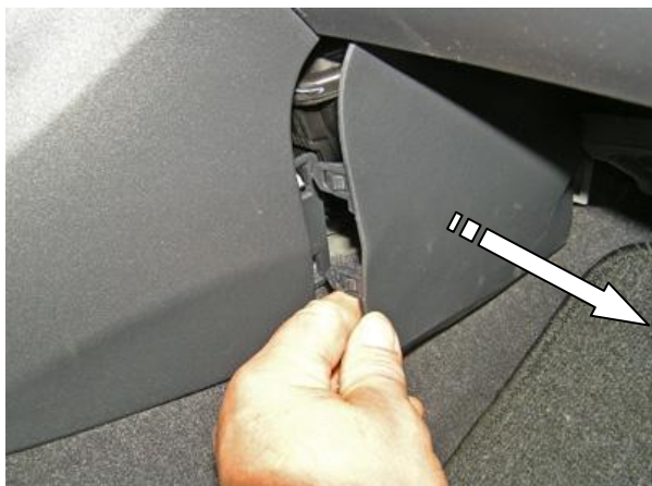
Снять боковые крышки с обеих сторон
