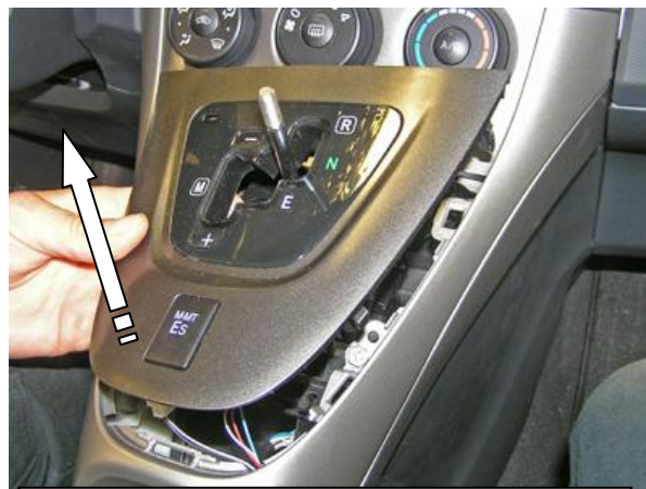
Снять переднюю верхнюю крышку
