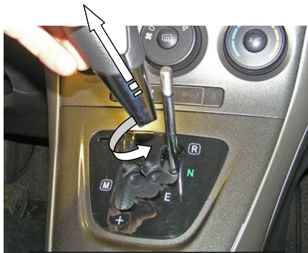
Открутить и снять рукоятку рычага переключения передач
