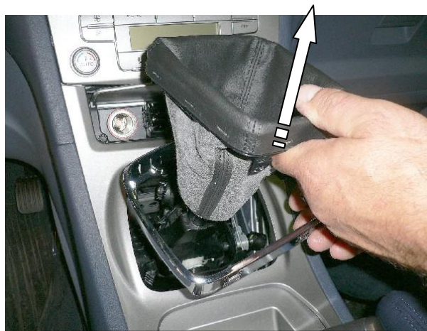
Снять декоративный кожух рычага переключения передач
