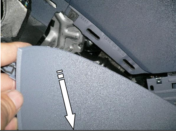
Снять боковые крышки с каждой стороны
