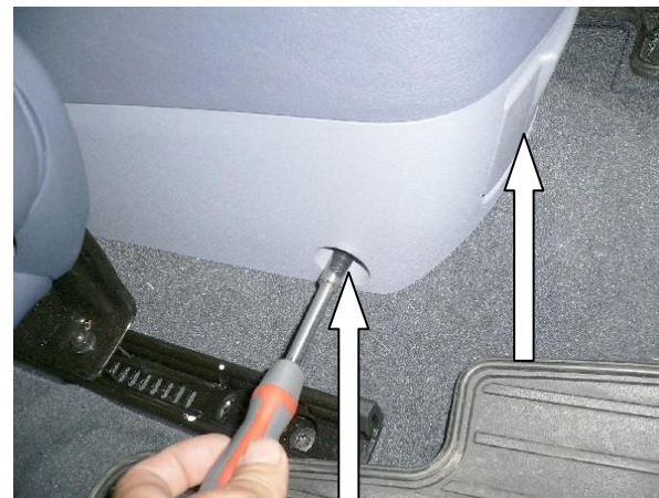
Сдвинуть передние кресла до упора вперёд, открутить саморезы с обеих сторон
