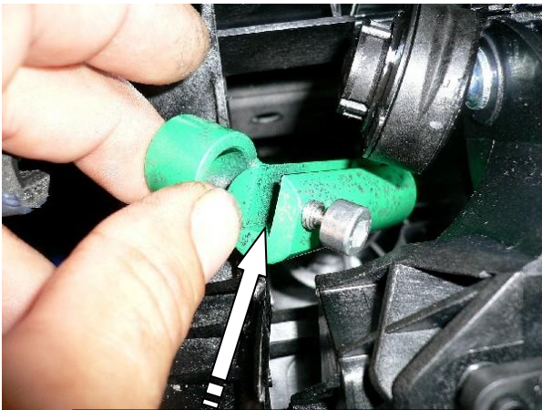
Установить хомут на тягу
