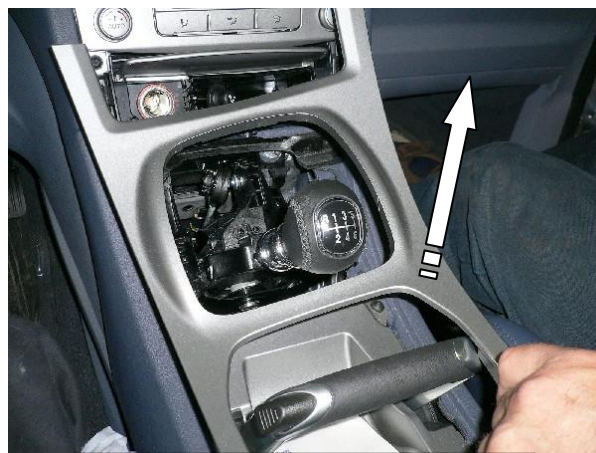
Снять декоративную панель
