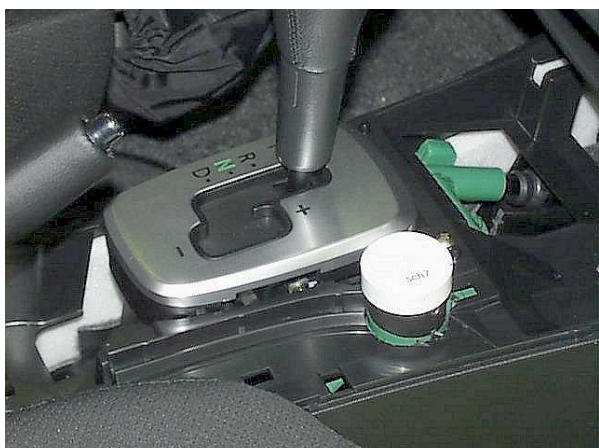
Установить консоль на место, ставить разметочный шаблон на корпус замка
