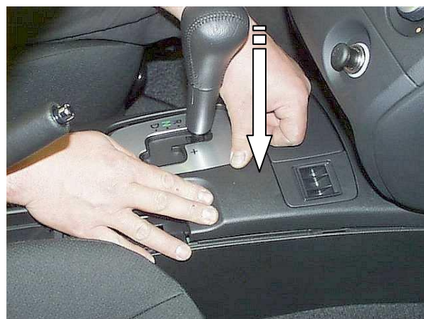
Разметить отверстие в верхней крышке под корпус замка
