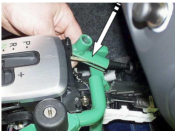
Установить хомут на тягу
