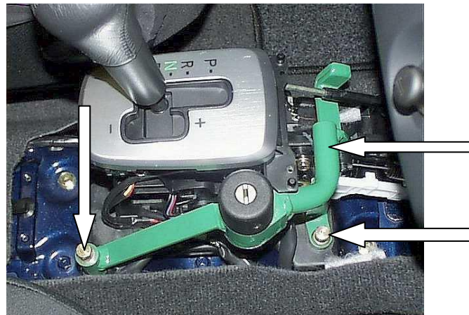
Установить замок, закрутить 3 болта
