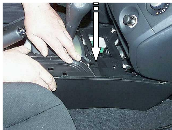
Разметить отверстие в консоли под корпус замка
