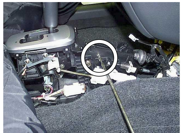
Просверлить отверстие в селекторе под трубу замка
